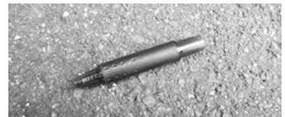
ポンプに混入していた物
