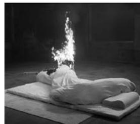
電気ストーブに布団が接触し出火した様子(実験写真)
